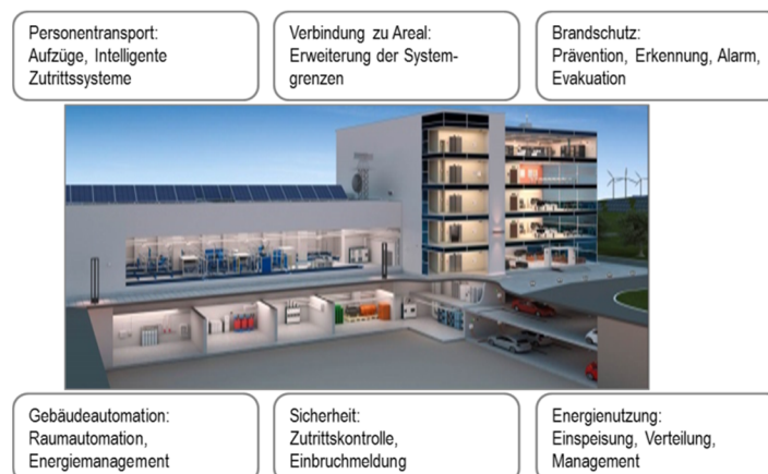
Abbildung 1: Übersicht "Intelligente Gebäude im System"
